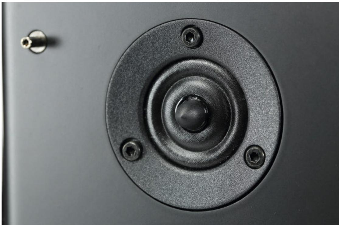
Table 3 MKII 使用俗稱尖鼻子高音的 Vifa XT-25-SC90，與一般絲質軟半球高音比較起來，尖鼻子高音的頻率響應更平順，擴散性更好。
